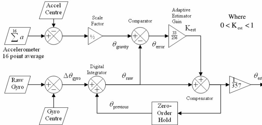
Fig. 9. Tilt Angle State Estimator
